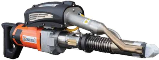
K- SB 50 es un extrusor potente e indispensable para las soldaduras que requieren un importante aporte de material. STARGUN K-SB 50 es el instrumento indicado para las soldaduras de geomembranas, planchas, tubos de grueso espesor y de todas aquellas soldaduras que deben resistir continuas solicitaciones. Es capaz de extrusar hasta 5 kg/h de material.
