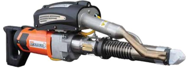
K- SB 60 es un extrusor potente e indispensable para las soldaduras que requieren un importante aporte de material. STARGUN K-SB 60 es el instrumento indicado para las soldaduras de geomembranas, planchas, tubos de grueso espesor y de todas aquellas soldaduras que deben resistir continuas solicitaciones. Es capaz de extrusar hasta 6.2 kg/h de material.
