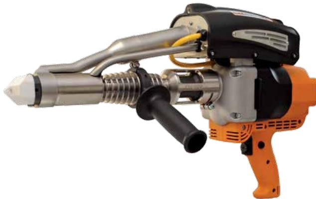
K-SB 40 es un extrusor compacto y preciso. K-SB 40 tiene un dispositivo regulador de potencia y un sistema de seguridad para el bloqueo del motor, que no le permite ponerse en marcha hasta que alcanza la temperatura de ejercicio. El Extrusor está dotado de una nueva placa "guía hilo" universal, que no tiene que ser sustituida cuando cambia el diámetro del material a extruir
