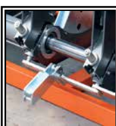
Despegue automático de la placa térmica
