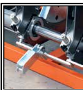
Despegue automático de la placa térmica
