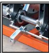
Despegue automático de la placa térmica
