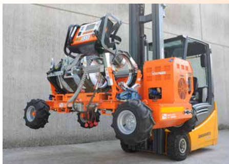
Delta 355 All Terrain sollevamento e movimentazione con muletto
