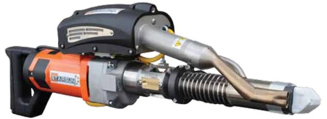
Stargun K-SB 60 es un extrusor potente, indispensable para trabajos que requieren un elevado aporte de material extruido. K-SB 60 es adecuado para la unión de lonas de geomembrana, planchas, tubos espesos y para todas aquellas soldaduras que tienen que aguantar continuas tensiones. Es capaz de extrusionar hasta 6,2 Kg/h de material.
