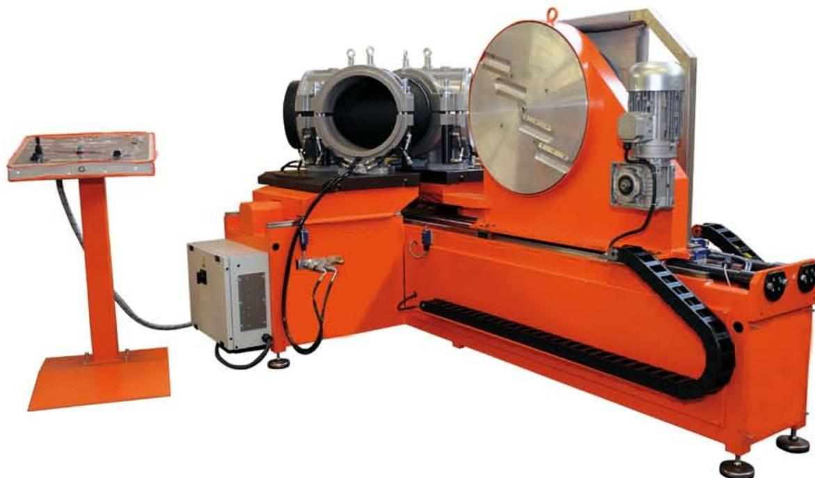
**ALFA 400 CTB** è una saldatrice in grado di realizzare raccordi come Curve (fino al Ø 400 mm), Braghe, Tee e Croci (fino al Ø 355 mm) tramite giunzione di segmenti di tubi. Le morse per Curve e Braghe vengono comandate idraulicamente per i movimenti apertura/chiusura/bloccaggio; quelle per Tee e Croci, l'apertura/chiusura è manuale. ALFA 400 CTB è in grado di saldare, grazie a "morse speciali", prestampati, raccordi speciali e colletti per flange. Costituita da:
