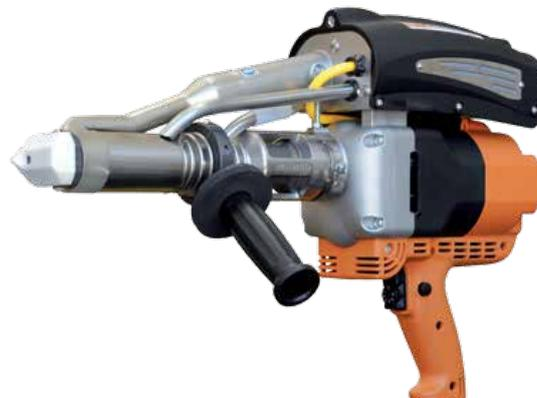
K-SB 30 è un estrusore maneggevole che salda secondo la norma DVS 2207. STARGUN K-SB 30 è dotato del sistema di regolazione della potenza, del dispositivo di sicurezza “blocco motore” che non permette la partenza fino al raggiungimento della Temperatura di esercizio. L’estrusore dispone di una innovativa placchetta guidafile che non va sostituita cambiando il diametro del filo da estrudere.
