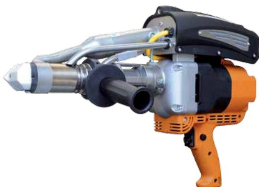
K-SB 20 è un estrusore compatto ed ergonomico che salda secondo la norma DVS 2207. K-SB 20 è dotato di un dispositivo di regolazione della potenza e del sistema di sicurezza “blocco motore” che non permette la partenza fino al raggiungimento della Temperatura di esercizio. L’estrusore dispone di una innovativa placchetta guidafile che non va sostituita cambiando il diametro del filo da estrudere.
