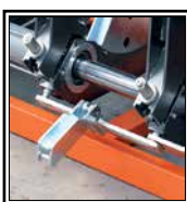
Despegue automático de la placa térmica
