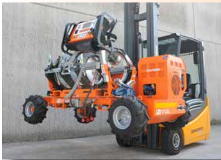
Delta 355 All Terrain levantamiento de la soldadora.
