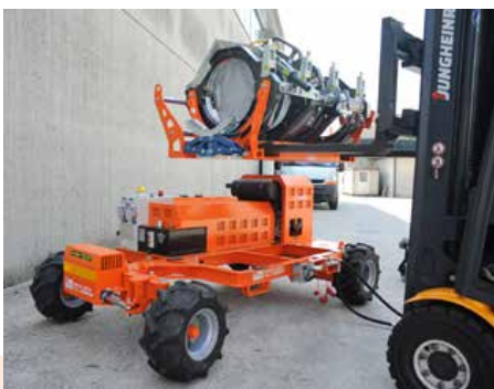
Sollevamento del solo corpo macchina
