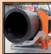
Rulliere laterali idrauliche
