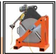
Soporte Placa térmica y Fresadora
