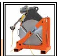
Soporte Placa térmica y Fresadora
