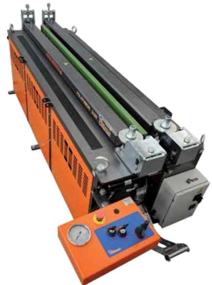
POLYFUSION 2-25 e POLYFUSION 2-50 sono saldatrici compatte e facile da usare con controllo della saldatura manuale, conformi allo standard di saldatura DVS 2207-1 e DVS 2207-11.
