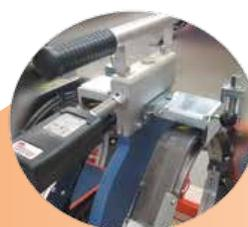
Termoelemento con dispositivo di sgancio rapido
