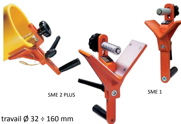
SME 2 PLUS Plage de travail \varnothing 40 ÷ 315 mm Épaisseur max 35 mm Dimensions 128 x 235 x 310 mm Poids 1,5 Kg
