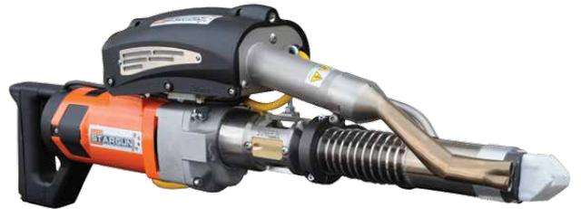
Stargun K-SB 60 est une extrudeuse indispensable pour les travaux qui demandent un débit élevé. K-SB 60 est appropriée pour souder les géomembranes, plaques, tubes de grande épaisseur et toutes les soudures qui sont continuellement sollicitées. Débit jusqu'à 6,2 kg/h.
