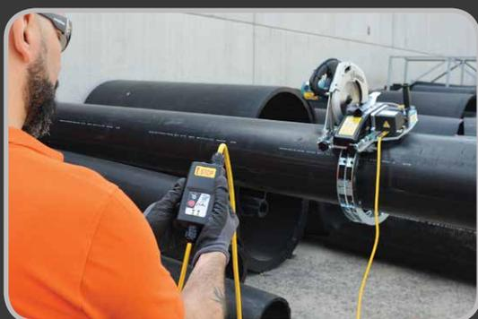
Il movimento orbitale automatico è gestito a distanza dall'operatore, che può intervenire in ogni istante tramite un pannello comandi.
