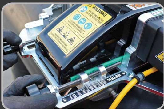
Facile e intuitiva regolazione del campo di lavoro. L'operazione avviene in opera una volta montati gli anelli in base diametro del tubo.
